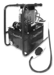
Модели НУЭА дополнительно оснащены реле времени, которое позволяет задавать время рабочего и обратного хода инструмента.
